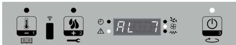
Visualização da mensagem que desliza no ecrã: AL 7 ALAR AL 7 SEGURANCA TERMICA
