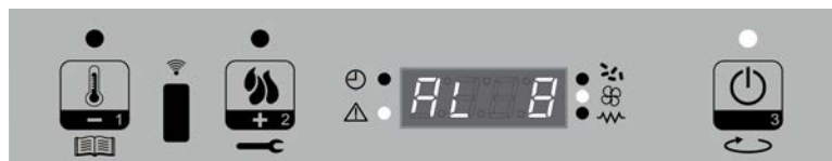
Visualização da mensagem que desliza no ecrã: AL 8 ALAR AL 8 FALTA DEPRESSAO
