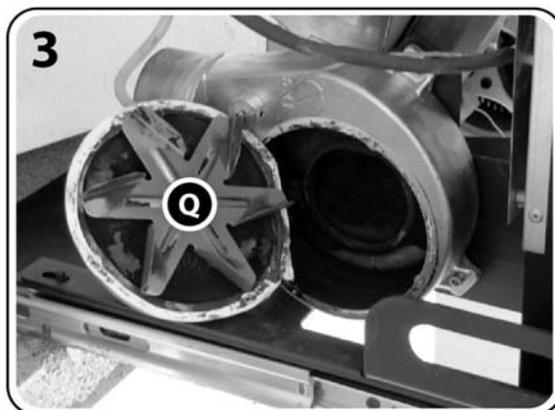
**i** L'extracteur des fumées [Q] ne peut pas être démonté de l'appareil à cause du câble électrique. Pour le nettoyer, il faut le poser à côté de l'appareil en prenant les précautions adéquates (voir figure 4).
