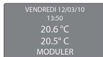
Lorsque la température ambiante dépasse de +3°C la température définie, l'appareil s'éteint en passant par les états de fonctionnement [Att.st-by] et [Stand-by].
