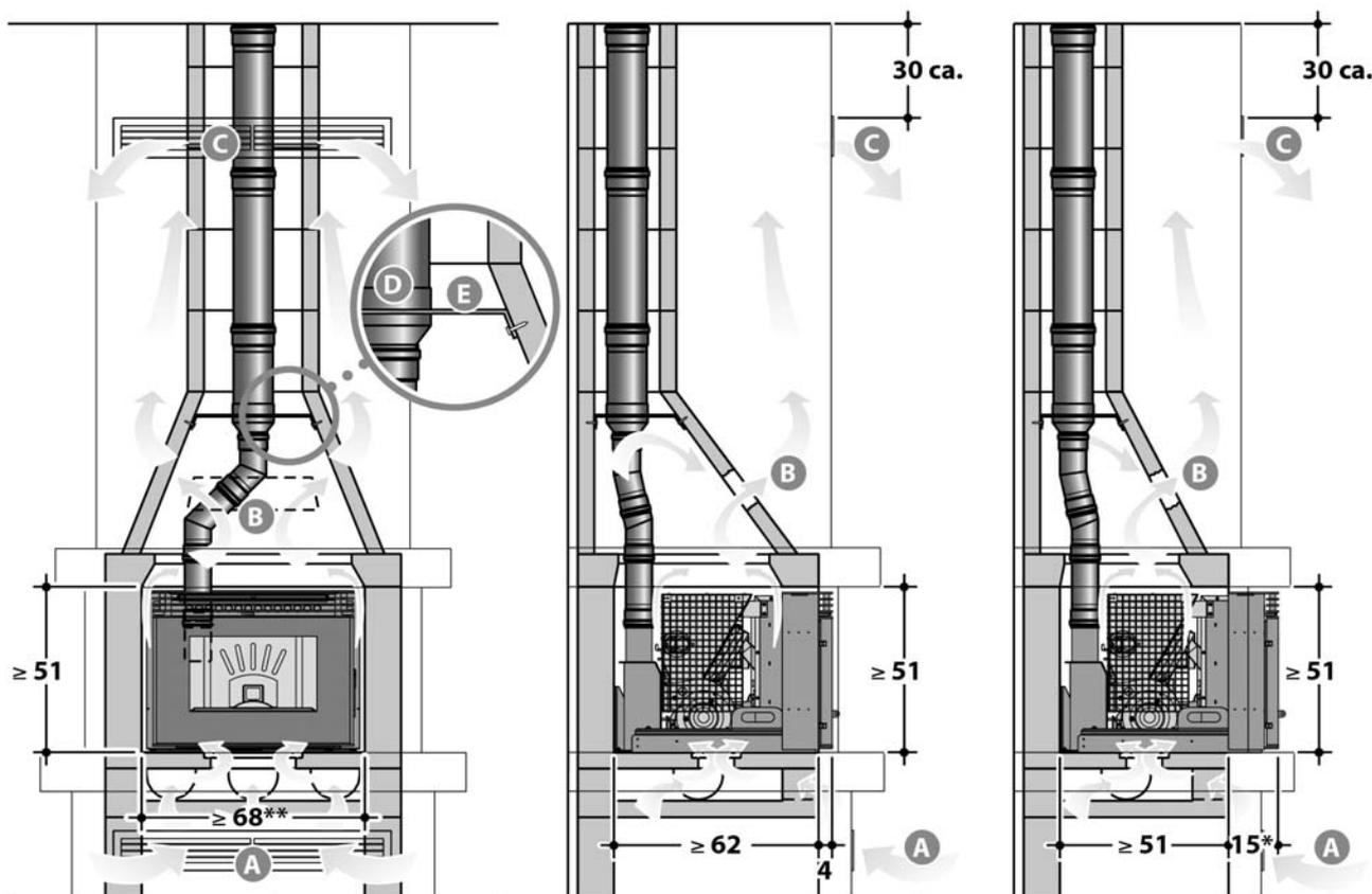
\* L'appareil est fini au dessus et sur les côtés pour pouvoir dépasser jusqu'à max 15 cm et permettre une profondeur réduite à min 51 cm.
