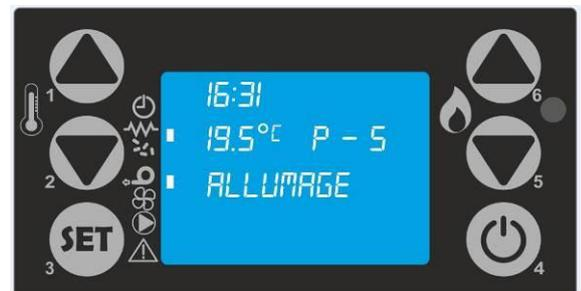
Les éventuelles anomalies au cours de la phase de démarrage sont signalées sur l'écran et l'appareil se met en alarme (voir paragraphe 2.10 et 4).
