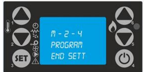
L'appareil dispose de deux programmes fin de semaine ce qui permet deux allumages et deux arrêts par jour, suivre les procédures ci-dessous pour les réglages: (les starts et stops sont initialement sur OFF)
