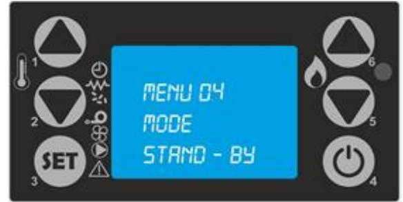
La fonction veille éteint l'appareil, si pendant plus de 3 minutes, la température ambiante est supérieure de 3°C à la température de consigne. L'écran affiche le message [WAIT OFF] (attente extinction). Au cours de cette phase, l'appareil arrête la vis sans fin, l'extracteur de fumée reste allumé jusqu'au refroidissement complet.
