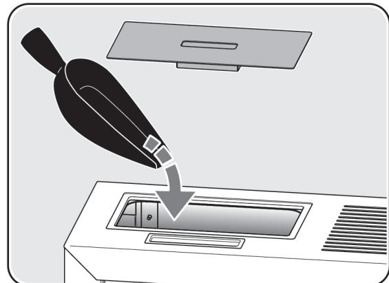
**!** ATTENTION: Pour le bon fonctionnement de l'appareil fermer toujours la porte du réservoir après le chargement en combustible.
