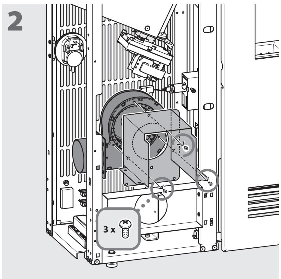
**Adaptation pour une sortie d'air chaud latérale (séquence 3a-4a-5a).**
