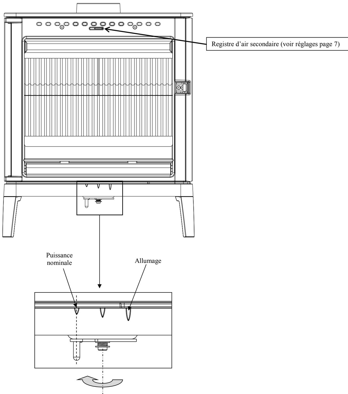
La position « Combustion Prolongée » est obtenue en tournant complètement le registre de réglage vers la gauche (après s'être assuré du maintien en activité de la post combustion)
