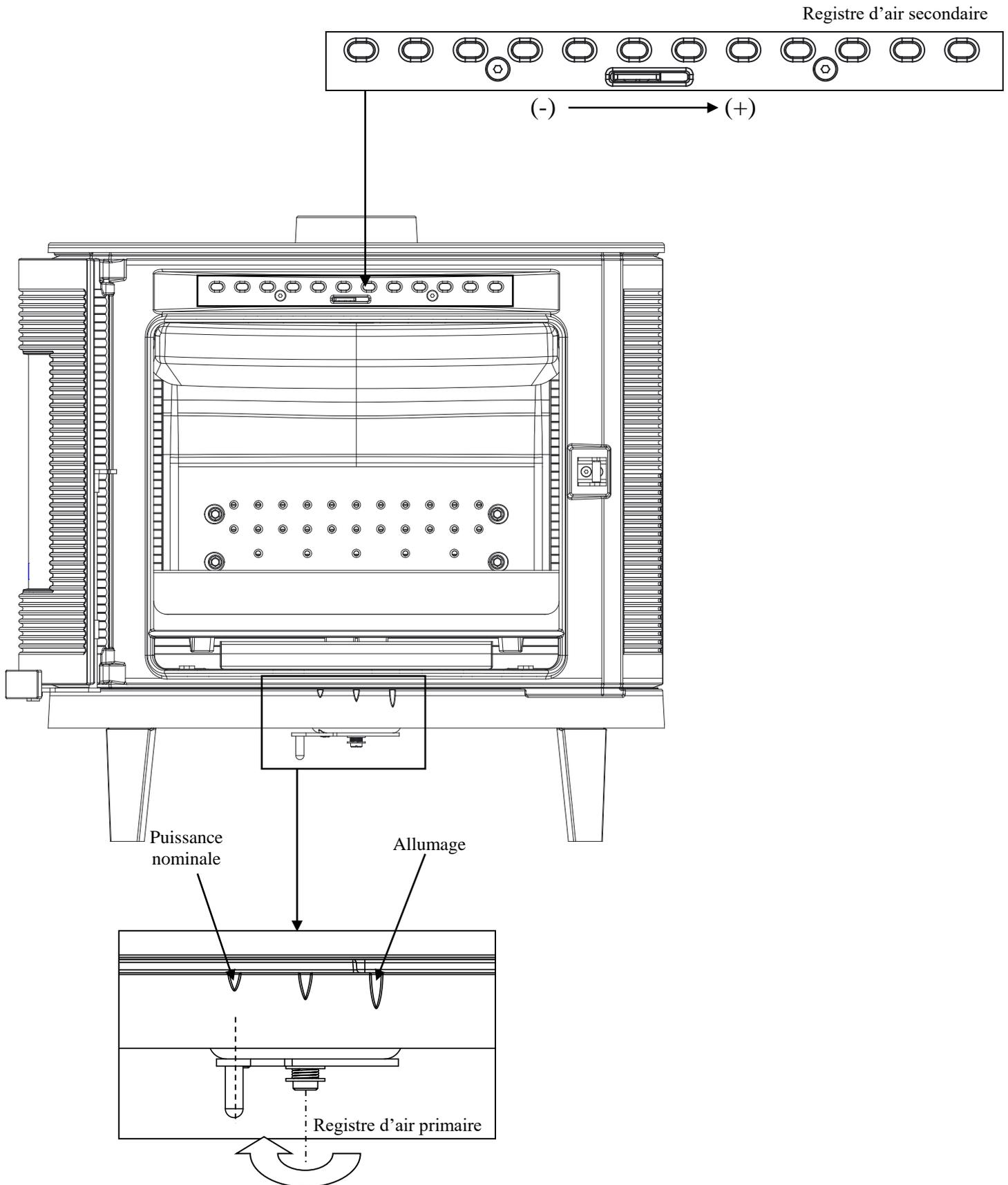
La position « Combustion prolongée » est obtenue en tournant complètement le registre de réglage vers la gauche.
