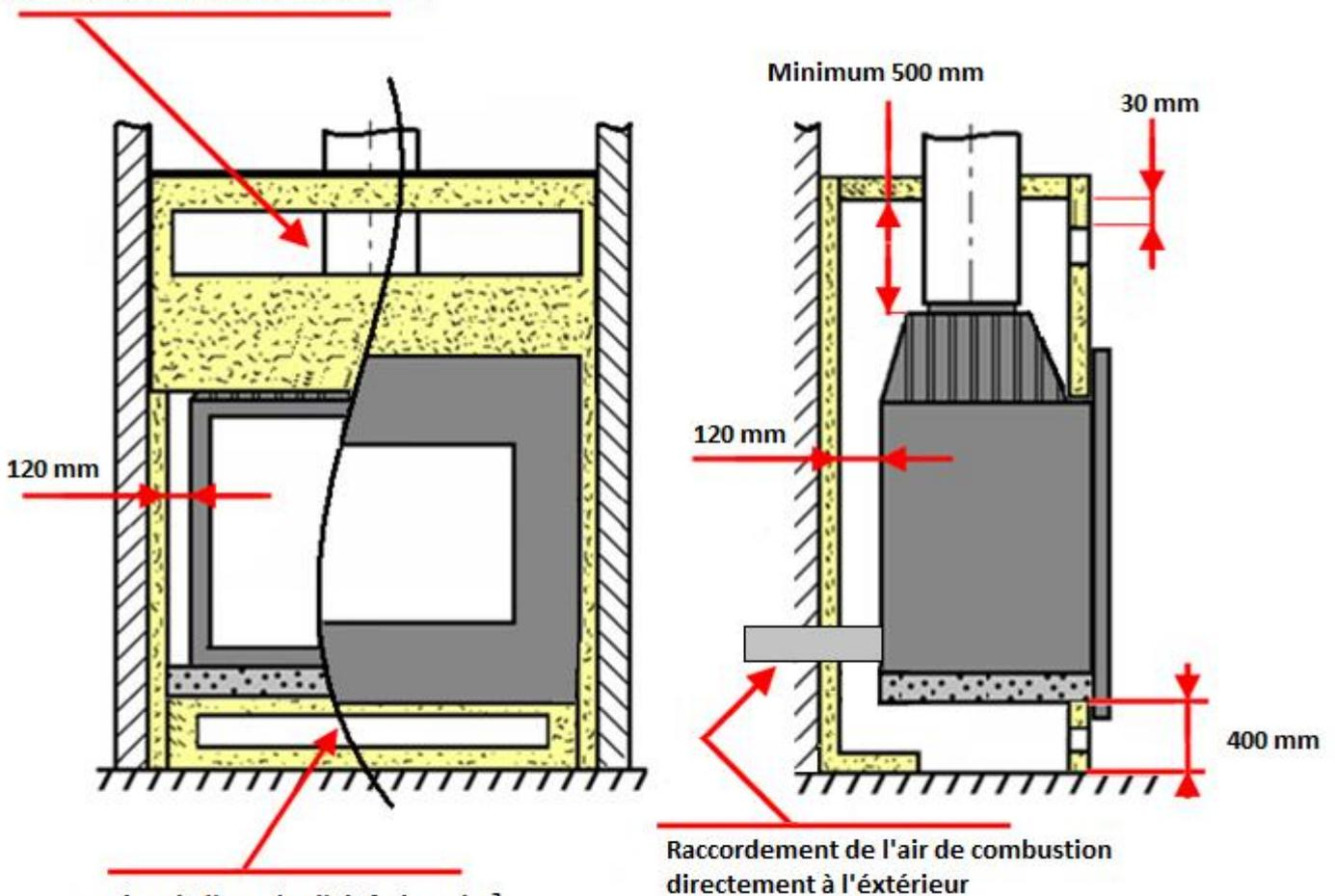
Section de l'entrée d'air frais: 8 dm<sup>2</sup>
