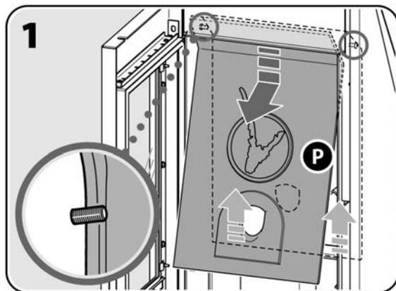
Retirer la plaque foyère [P] en l'inclinant et en faisant attention de ne pas heurter le corps de l'appareil.
