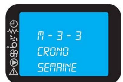
L'appareil dispose de quatre programmes hebdomadaires qui permettent quatre allumages et quatre extinctions par jour. Pour chaque plage horaire programmée, il est également possible de définir la puissance maximale de fonctionnement et la température ambiante.
