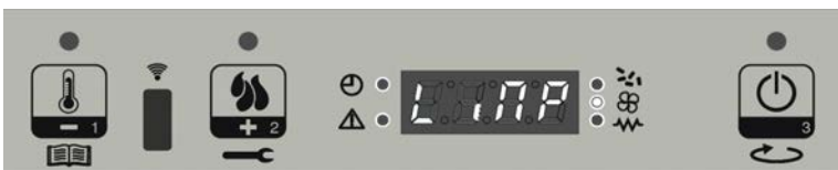
Visualización del mensaje que se desplaza en la pantalla: LIMPIEZA QUEM
