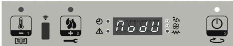
Visualización del mensaje que se desplaza en la pantalla: MODULA
