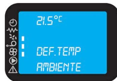
Quando a temperatura ambiente atinge o valor ajustado, a potência do aparelho vai automaticamente para o valor mínimo. Nestas condições, o ecrã exibe a mensagem [TRABALHO MODULAÇÃO].
