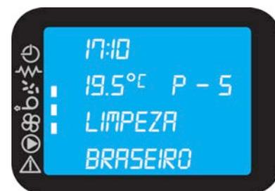
**ATENÇÃO:** Se a ignição não acontecer, o aparelho vai para o estado de alarme de "Falha de ignição" e no ecrã aparece a mensagem [FALHA DE IGNIÇÃO].
