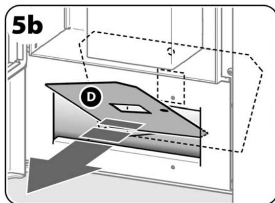
6. Remova a fuligem com uma pá e, em seguida, aspire bem a fuligem e as cinzas que permaneceram no interior do compartimento de recolha de pós do permutador de calor utilizando um aspirador de pó.
